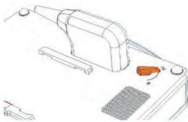
Fig. Connecteur de la sonde correctement ajusté au port.
